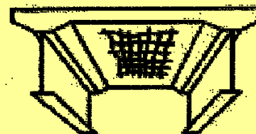
③上面へ貫通ひび割れ
