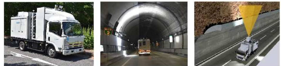
トンネル内の走行型計測調査のイメージ
